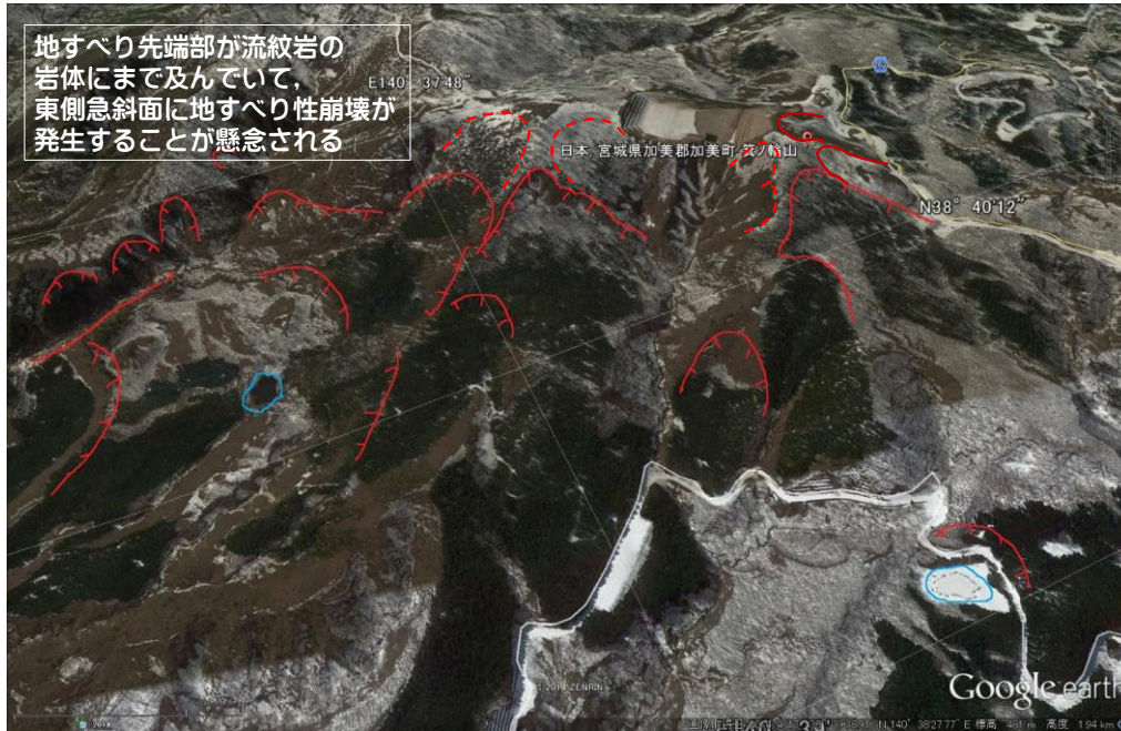
図 12 箕ノ輪山を東方から眺める Google earth の画像. 箕ノ輪山山頂は二ツ石ダムの採石場跡地になっていて、そこが処分場候補地である. 敷地には 2, 3 の地すべりが及んでいることに注意.
