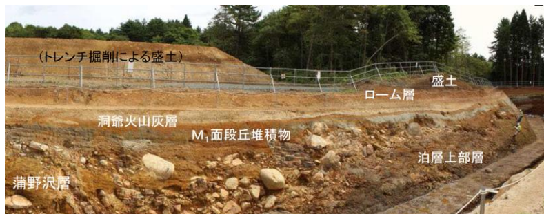
Fig. 13 トレンチ Tr-30 北面の写真。基盤岩の泊層の岩盤劣化が著しいが、 M_1 面段丘堆積物の礫の風化が格段と軽微あることに注目。
